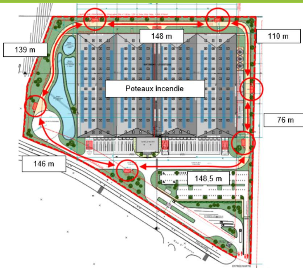
Emplacement des poteaux incendie
